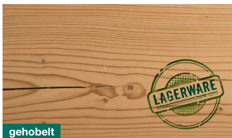
gehobelt sehr glatte Oberfläche, zum Teil glänzend
