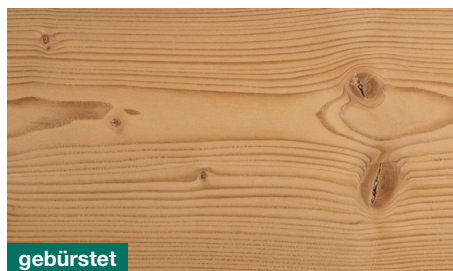
gebürstet feine Struktur, Bearbeitung mit Kunststoffbürsten
